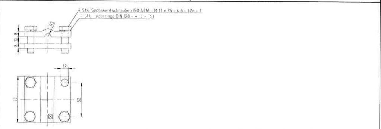
Клема заземителна лентов заземител и кръгъл заземител. Erdungsklemme fuer Bänderder und Runderder. Номенклатурен номер: 2705010001 Material – Nummer: 2705010001
