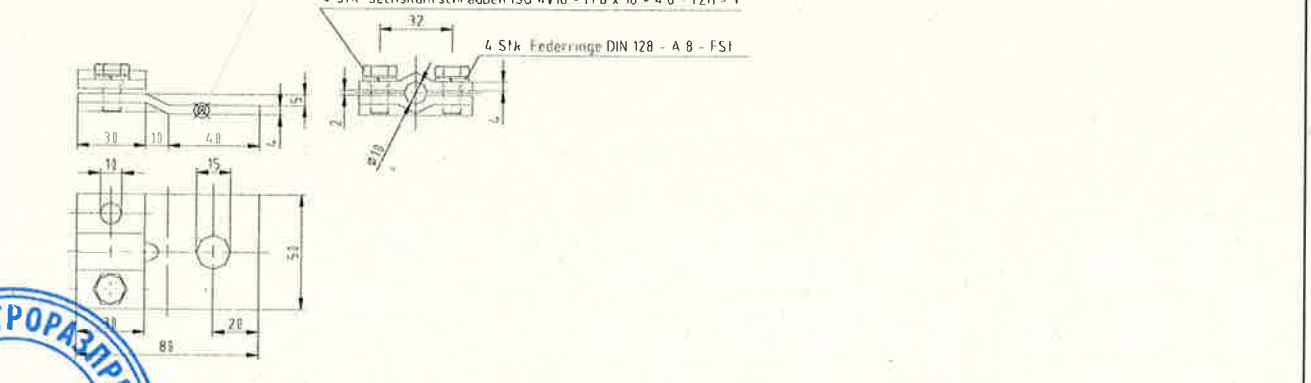
Клема заземителна кръгъл заземител – планка. Erdungsklemme Runderder - Platte. Номенклатурен номер: 2705010004 Material – Nummer: 2705010004
