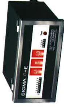
**Kurzschluss-/Erdschlussanzeiger Typ Horstmann SIGMA F+E /oder gleichwertiges Produkt/** mit phasenselektiver Anzeige im Schalttafelgehäuse. Die Anzeige erfolgt über bistabile Schanzeichen, die entweder von Hand über die Fernsteuerung oder automatisch nach 2h (3h) zurückgestellt werden.
