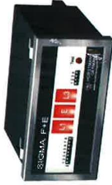
**Индикатор за късо и земно съединение тип Horstmann SIGMA F+E /или аналог/** с фазово-селективно отчитане в модулния корпус на разпределителното табло. Отчитането се извършва посредством двузначен показателен сигнал, който се освобождава ръчно или посредством дистанционно управление или автоматично след 2 часа (3 часа).
