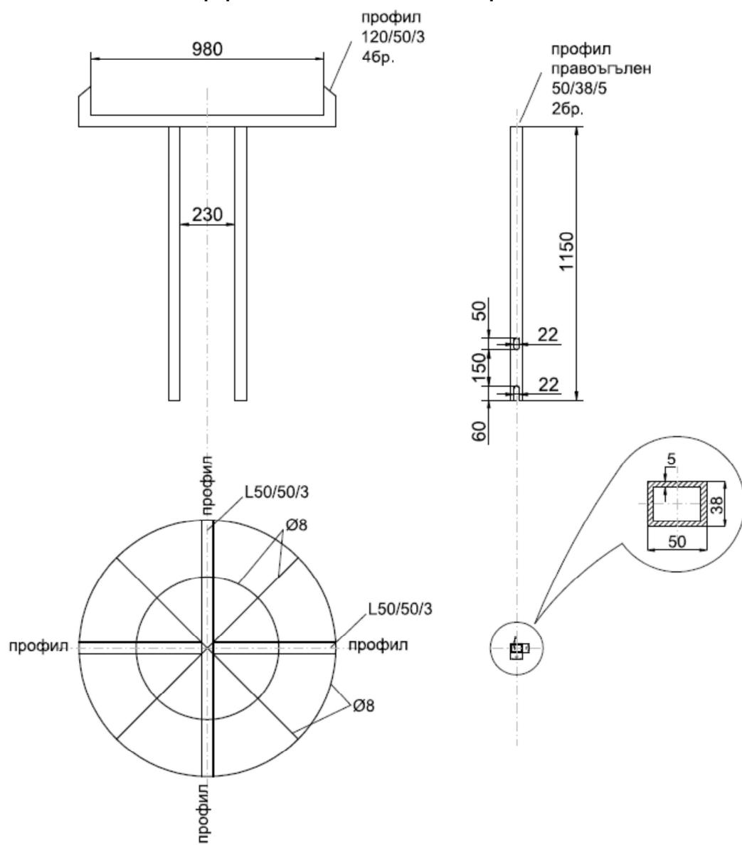
Пояснение към чертежа: Два винкела в основата на гнездото / 50/50/3мм / и спомагателните профили Ф8 да са заварени по начин, обезпечаващ равната повърхност на дъното, но не за сметка на стабилността му. Носещите два □ -профила / 50/38/5мм /, като страната им където са прореза и отвора трябва да е ориентирана успоредно на стълба, за да се захване на горните две куки.
