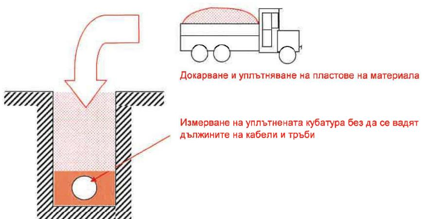
Поз. 10 Доставка и полагане в изкоп на PVC тръба до ф160 mm в бетонов кожух.
