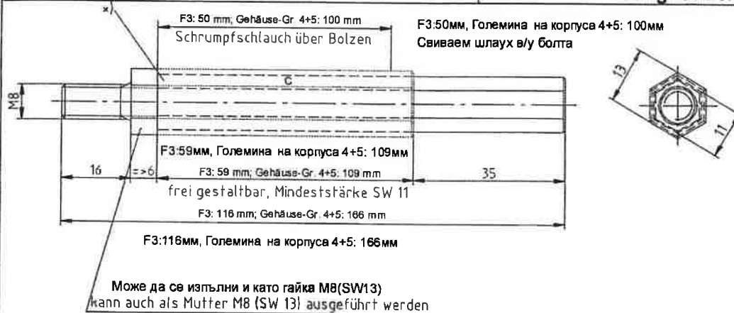
Bild 1: Erdungsbolzen
