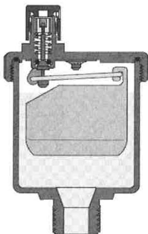
Обезвъздушителите трябва да се с месингови корпус и капак, поплавък от висококачествен полипропилен, и уплътнения от температуроустойчив еластомер, хигроскопична капачка. Обезвъздушителя трябва да работи в среда с вода или етиленгликолен разтвор. Отдушника да е с пружина и лостова система от неръждаема стоманена.
