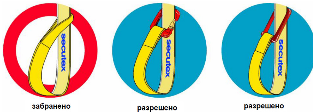
Фиг. 3.6.7 - 12 Окачване със стягане.
