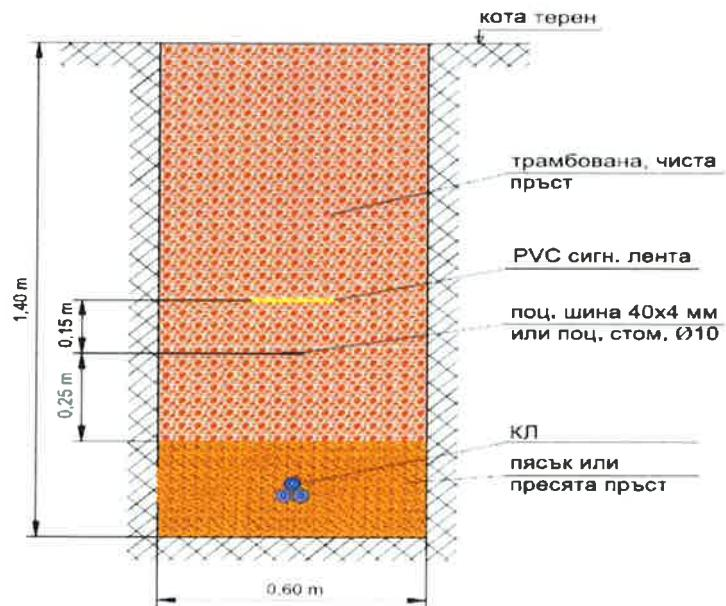
Поз. 5 Трасиране и направа на изкопи за кабели с широчина до 0,40m, дълбочина до 0,90m без повторно запълване ( в m<sup>3</sup> )
