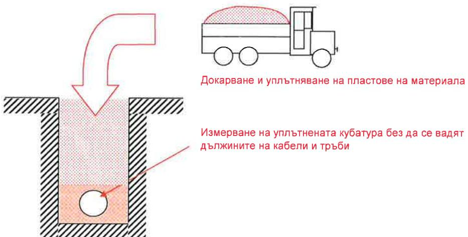
Поз. 17 Доставка и полагане в изкоп на PVC тръба до ф160 mm в бетонов кожух.
