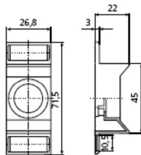
Die Sockel für die Schraubsicherung D0-63A sind mit der Bezeichnung oder dem Logo des Herstellers und dem Sockeltyp zu markieren.
