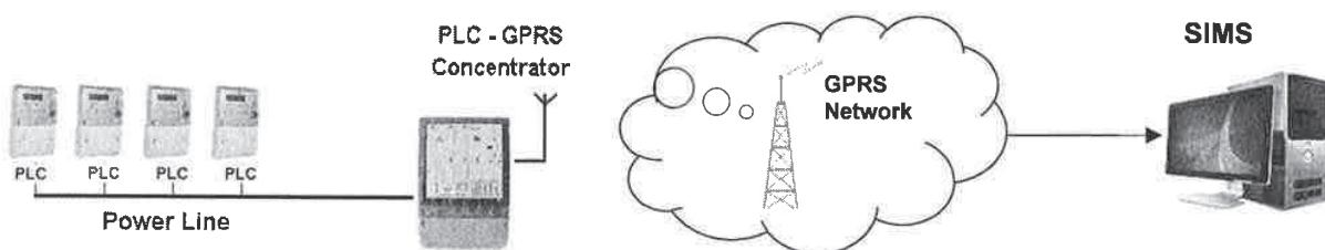
Всички електромери, монтирани в една мрежа ниско напрежение (НН) на даден трафопост (ТП) осъществяват двупосочна комуникация с маршрутизатор, монтиран в ТП. Комуникацията се извършва по захранващите линии на мрежата (PLC). Обменят се отчетени данни, данни за събития, команди за управление и параметризиране на електромерите.
