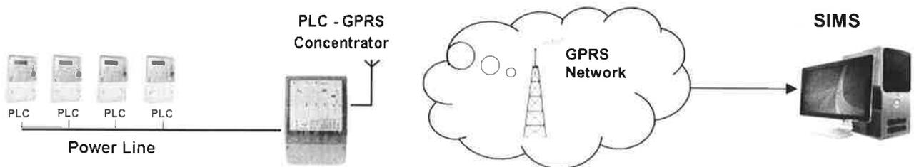
Всички електромери, монтирани в една мрежа ниско напрежение (НН) на даден трафопост (ТП) осъществяват двупосочна комуникация с маршрутизатор, монтиран в ТП. Комуникацията се извършва по захранващите линии на мрежата (PLC). Обменят се отчетени данни, данни за събития, команди за управление и параметризиране на електромерите.
