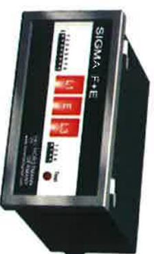
**Kurzschluss-/Erdschlussanzeiger Тур Норстманн SIGMA F+E /oder gleichwertiges Produkt/** mit phasenselektiver Anzeige im Schattatfelgehäuse. Die Anzeige erfolgt über bistabile Schanzeichen, die entweder von Hand über die Fernsteuerung oder automatisch nach 2h (3h) zurückgestellt werden.
