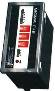
**Индикатор за късо и земно съединение тип Норстманн SIGMA F+E /или аналог/** с фазово-селективно отчитане в модулния корпус на разпределителното табло. Отчитането се извършва посредством двузначен показателен сигнал, който се освобождава ръчно или посредством дистанционно управление или автоматично след 2 часа (3 часа).
