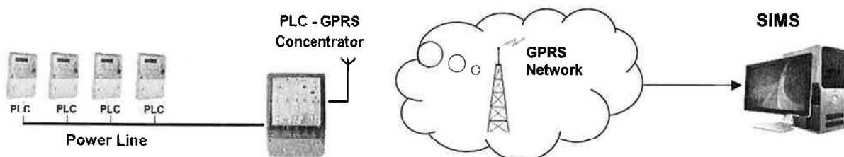
Всички електромери, монтирани в една мрежа ниско напрежение (НН) на даден трафолост (ТП) осъществяват двупосочна комуникация с маршрутизатор, монтиран в ТП. Комуникацията се извършва по захранващите линии на мрежата (PLC). Обменят се отчетени данни, данни за събития, команди за управление и параметризиране на електромерите.
